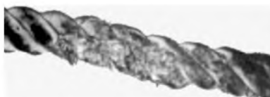
Рисунок С.11 — Механические повреждения
